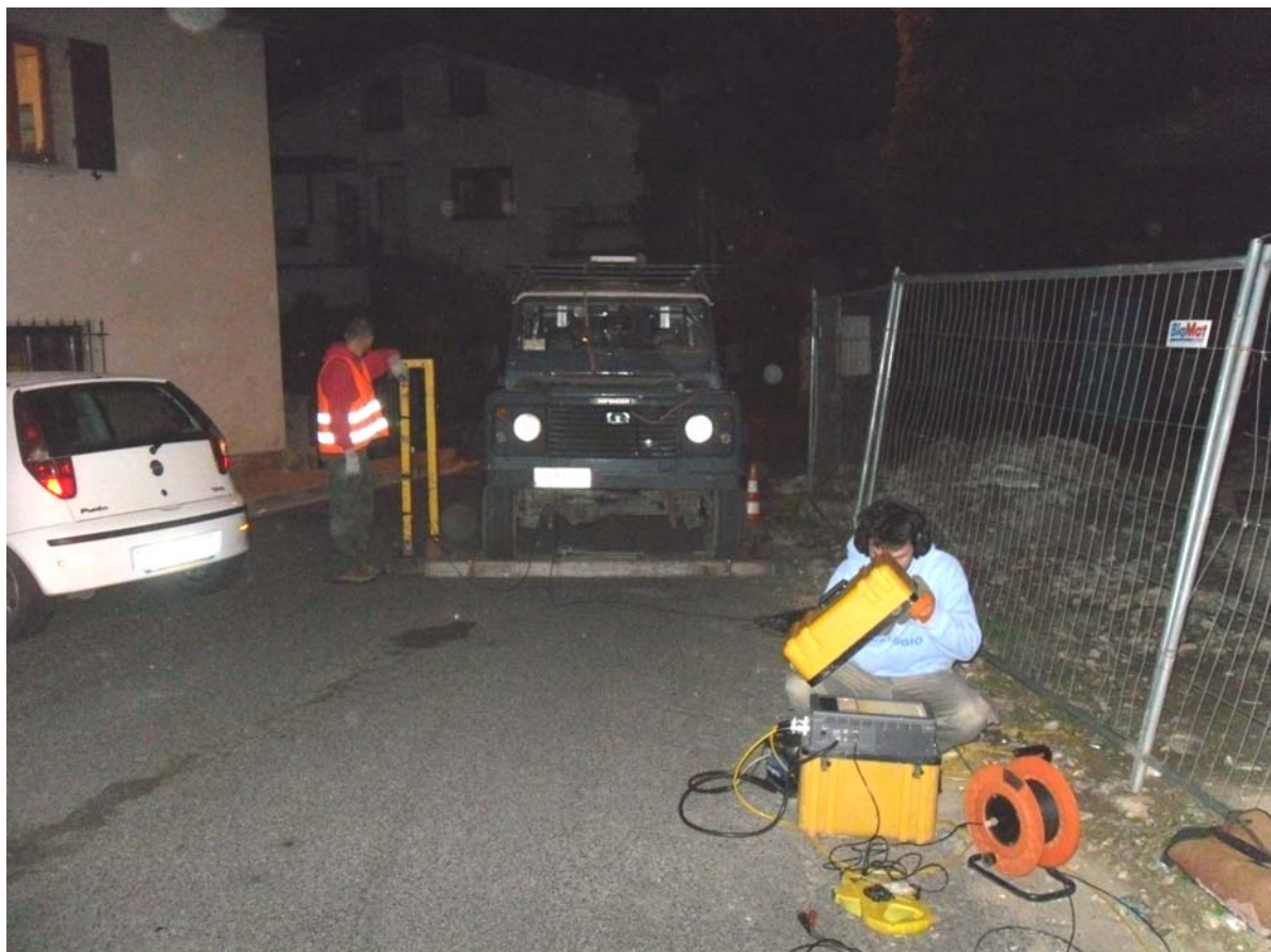
Foto n.3 Fase di energizzazione con il pendolo per la creazione di onde SH.
